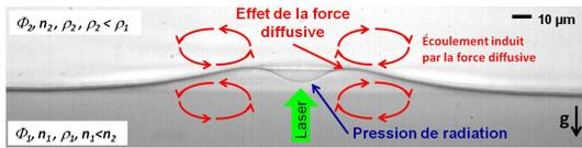
Fig. 1: Mécanismes de déformation d'une interface fluide (propagation du milieu le moins réfringent vers le plus réfringent),  $n_i$  et  $\rho_i$  sont respectivement l'indice de réfraction et la densité du fluide  $i$ . ( $T - T_c = 1$  K,  $\omega_0 = 9.8\mu\text{m}$  et  $P = 1000$  mW)
